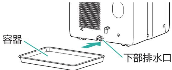
2 下部排水口から下部排水ゴム栓を取り外して排水する
