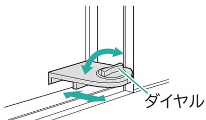
手前と奥の窓や窓パネルとの間に、隙間がなくなるまで窓の戸を端へ押し付け、補助鍵を窓枠に挿入する
